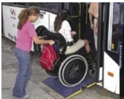
Os modelos novos de ônibus terão pisos baixos e rampas de acesso para cadeirantes
